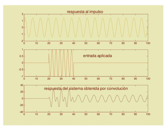
Comportamiento del sistema para valores M=1, K=1, y R=0. Señal aplicada: una frecuencia única durante un lapso corto de tiempo.
